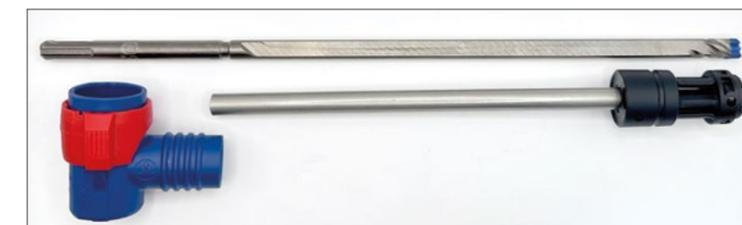
Die EXPERT SDS Clean Absaugung kann komplett in Bohrer, Absaugrohr, und Entstauberadapter zerlegt und gereinigt werden. Ist etwas defekt, können die verschiedenen Teile einzeln ausgetauscht werden.
