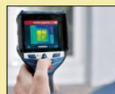
Schon länger im Programm ist die präzise vielseitige **Wärmebildkamera GTC 600 C Professional**. Sie nimmt in einem Messbereich zwischen -20 und +600 Grad Celsius Wärmebildern mit einer Auflösung von 256 x 192 Pixeln auf und erfasst so Temperaturunterschiede schnell und zuverlässig.
